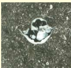
V.l.n.r.: Centrale hal Burgerzaken, Belgische hardsteen met brachiopodenschalen, crinoïden en koraalfragmenten.
